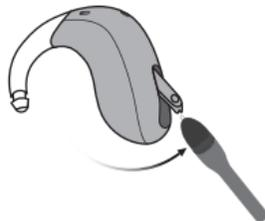
Drücken Sie das Werkzeug in die Öffnung, und ziehen Sie es wieder heraus, um die Tasterabdeckung zu öffnen. Halten Sie dabei das Multifunktionswerkzeug wie dargestellt, um Schäden zu vermeiden.
