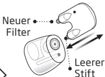
Drücken Sie den leeren Stift in den Cerumenschutz im Ohrstück. Ziehen Sie den alten Cerumenschutz heraus.
