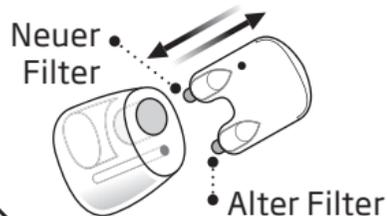
Setzen Sie den neuen Cerumenschutz mit dem anderen Stift ein. Entfernen Sie das Werkzeug, und entsorgen Sie es.
