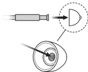
Setzen Sie den Dünnschlauch exakt in die Mitte des Ohrstücks, damit er fest sitzt.
